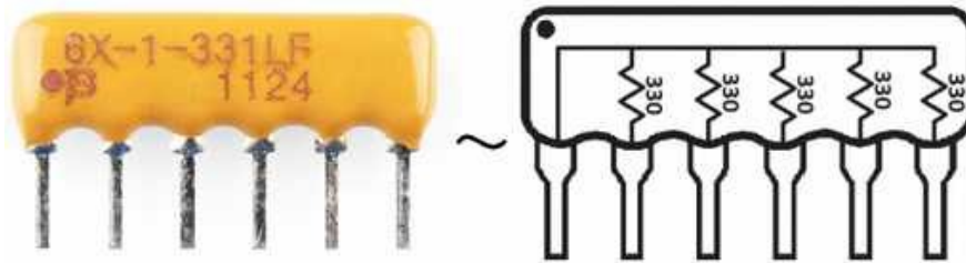
Een serie van vijf 330 \Omega weerstanden, allemaal aan één uiteinde samengebonden.
